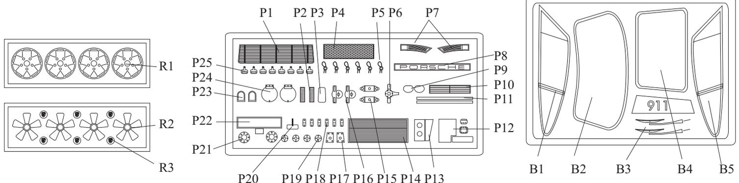
**Intérieur:** Pour réaliser les harnais noirs, coupez des lanières dans du plomb de bouteille de bon vin, et enfitez-les dans les boucles P16-P25. Garnissez le siège et collez-le en place, les harnais arrières venant se coller sur la plage arrière. Collez le pédalier et repose-pieds, puis mettez l'arceau en place. Ajoutez-y le tableau de bord équipé du volant et décoré, ainsi que l'extincteur rouge.
